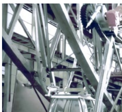
Notstopp-Fangseil-Dämpfung vor Schleuse // Emergency stop rope damping in front of water lock
